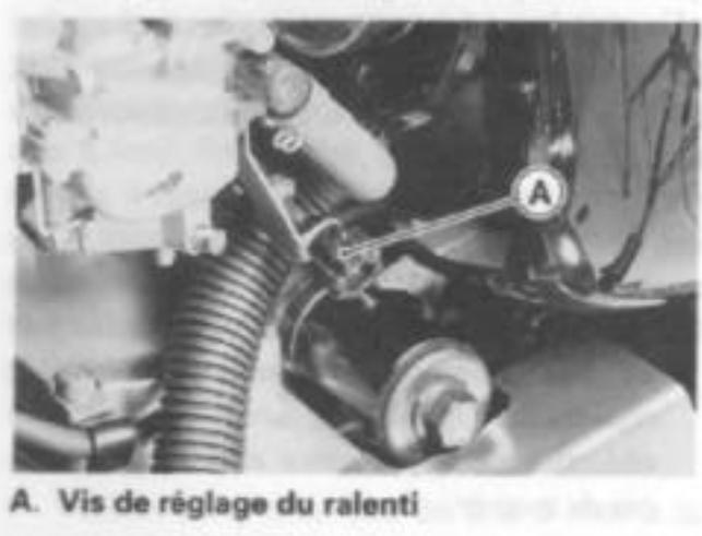
\* Le moteur tournant au ralenti, faire pivoter le guidon d'un côté à l'autre. Si le mouvement du guidon modifie le ralenti, il se peut que les câbles d'accélération soient mal réglés, mal acheminés ou endommagés. Remédier à ces problèmes avant de prendre la route.
